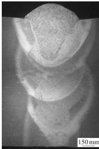
图 7 焊缝横截面金相图
