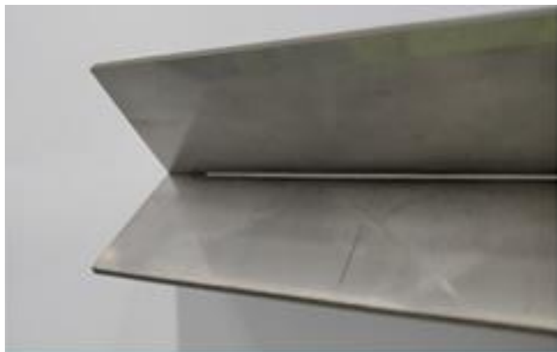
角缝 (阴角) 焊接
