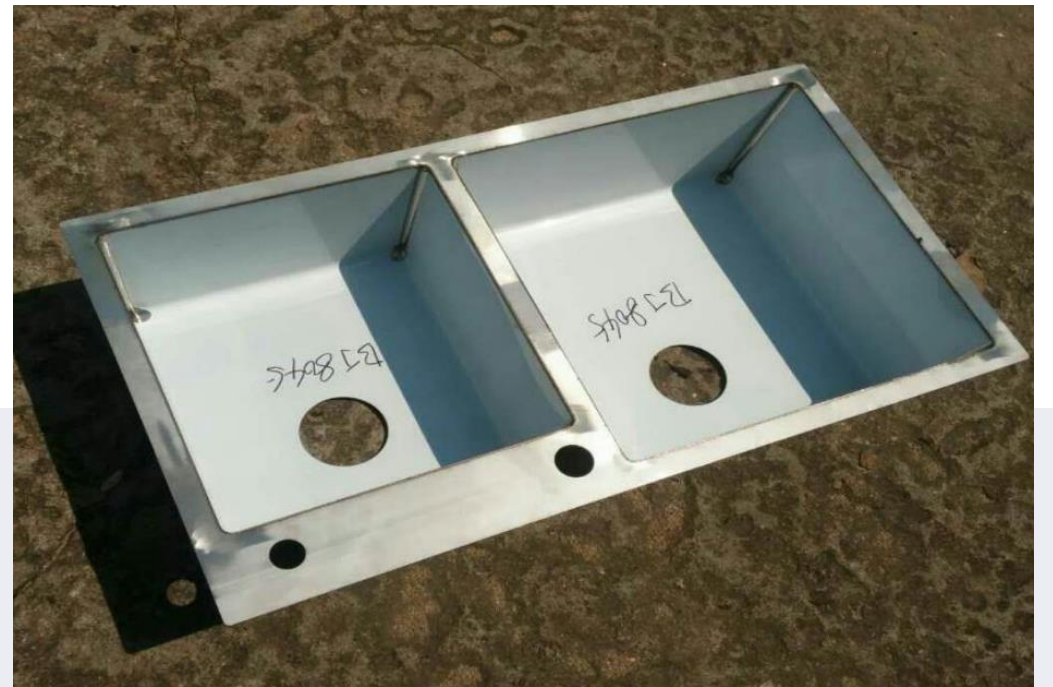
半导体激光器焊接不锈钢水槽
