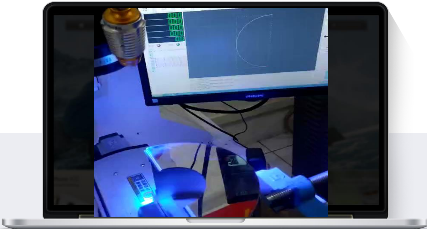
半导体激光器焊接不锈钢水槽
