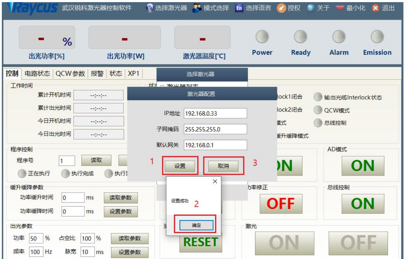
图 36 激光器修改 IP 地址步骤
