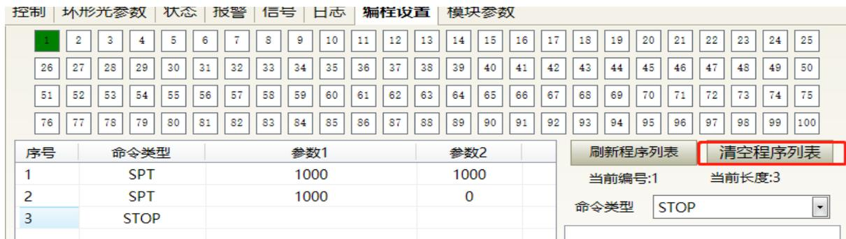
图 62 清空当前激光器波形模式下存储的所有波形操作界面
