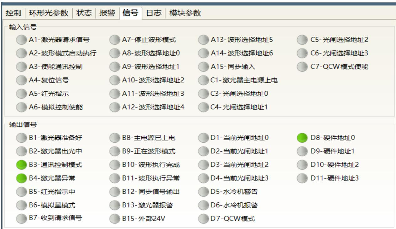
图 53 诊断模式下的接口状态指示界面
