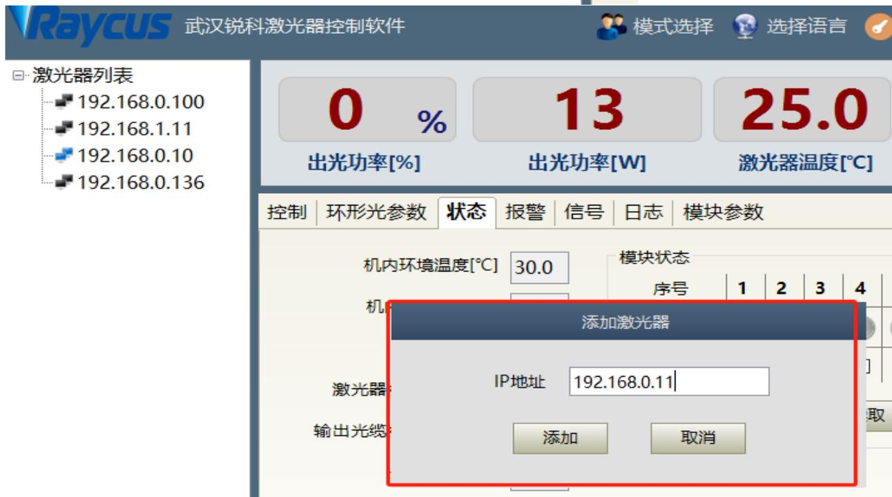
图 37 上位机软件中添加激光器的操作步骤
