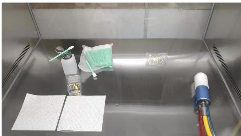
图 6 放置于开启抽风的洁净工作台中的输出光缆
