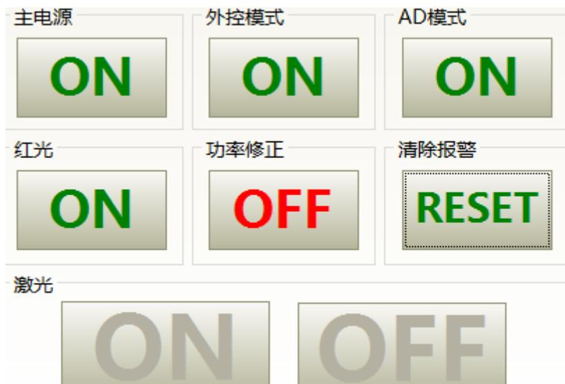
图 42 激光器上电、模式选择、出光控制显示区
