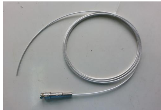
图 12 调制信号电缆线
