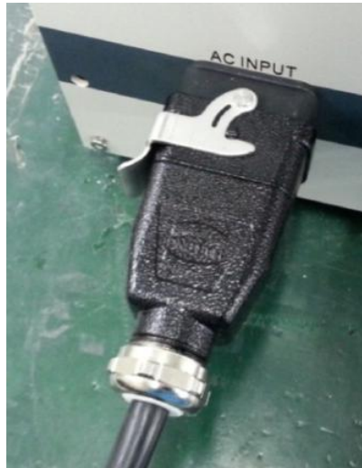
图 9 用锁扣锁上插头
