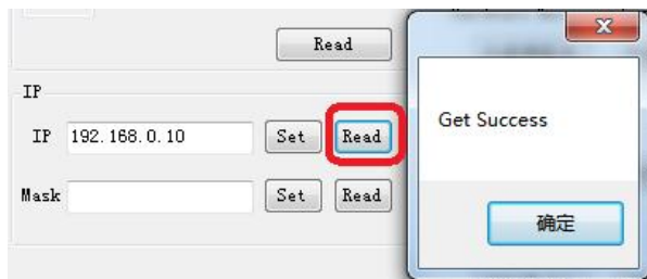
图 13 主界面——激光器 IP 读取 点击“读取”按钮，可读取当前激光器的 IP 地址 192.168.0.10。
