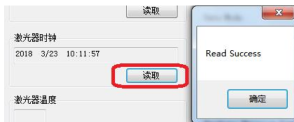
图 11 主界面——激光器时钟 点击“读取”按钮，可读取激光器当前时钟信息。
